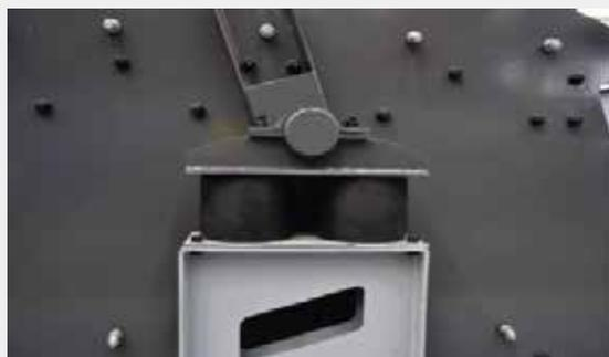
筛机支撑采用橡胶弹簧
